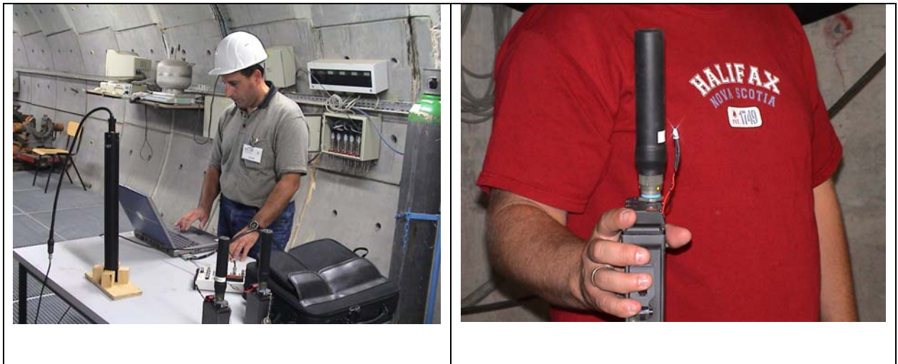
Figuur 21: meetopstelling aan de ontvangtzijde met grote antenne (links) en handontvanger (rechts). LED's op deze ontvanger in de verbindingsgalerij geven ontvangst aan van de doorgestuurde code
