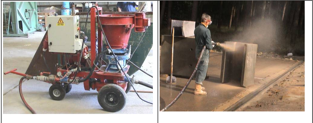
Figuur 11: foto's van guniteringsmachine en guniteringstesten
